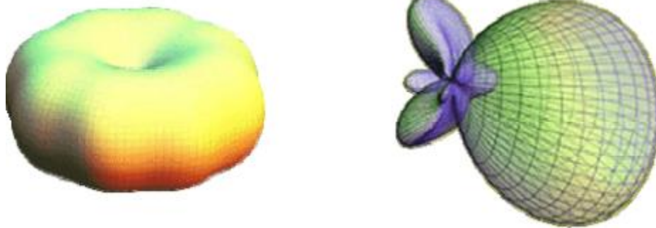
Hình 2.7. Đồ thị phương hướng của anten omni-direction và anten có hướng
